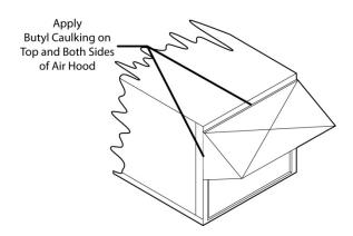
Figure 5 - 75-140 ton Open Rain Hood
